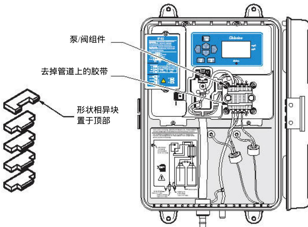
图16 安装泵/阀组合夹紧板
